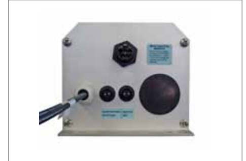
Figura 4: Parte inferior del controlador con clavijas precableadas
